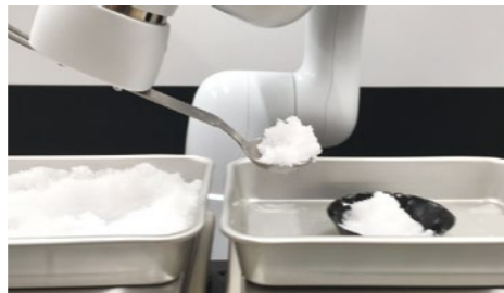
ロボットによる粉体計量 (2018) (エクサウィザーズ、デンソーウェーブ) *筆者はエクサウィザーズの技術顧問
