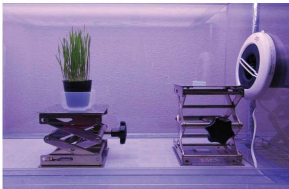
植物に対する昆虫の飛翔応答を調べる風洞試験の様子
